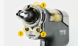
Durch Lösen von 3 Schrauben
